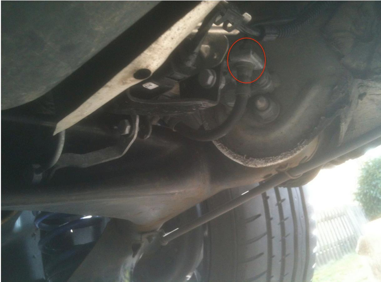
Wo hier im Bild der Halter für den Niveausensor befestigt ist, ist original eine Halterung für Bremsleitung und Bremsschlauch.
