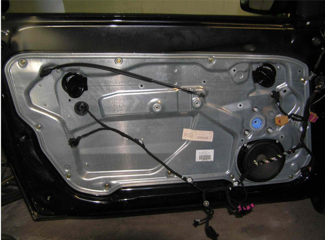
16. Den gesamten Aggregateträger nach unten/links aus der Tür heben.
