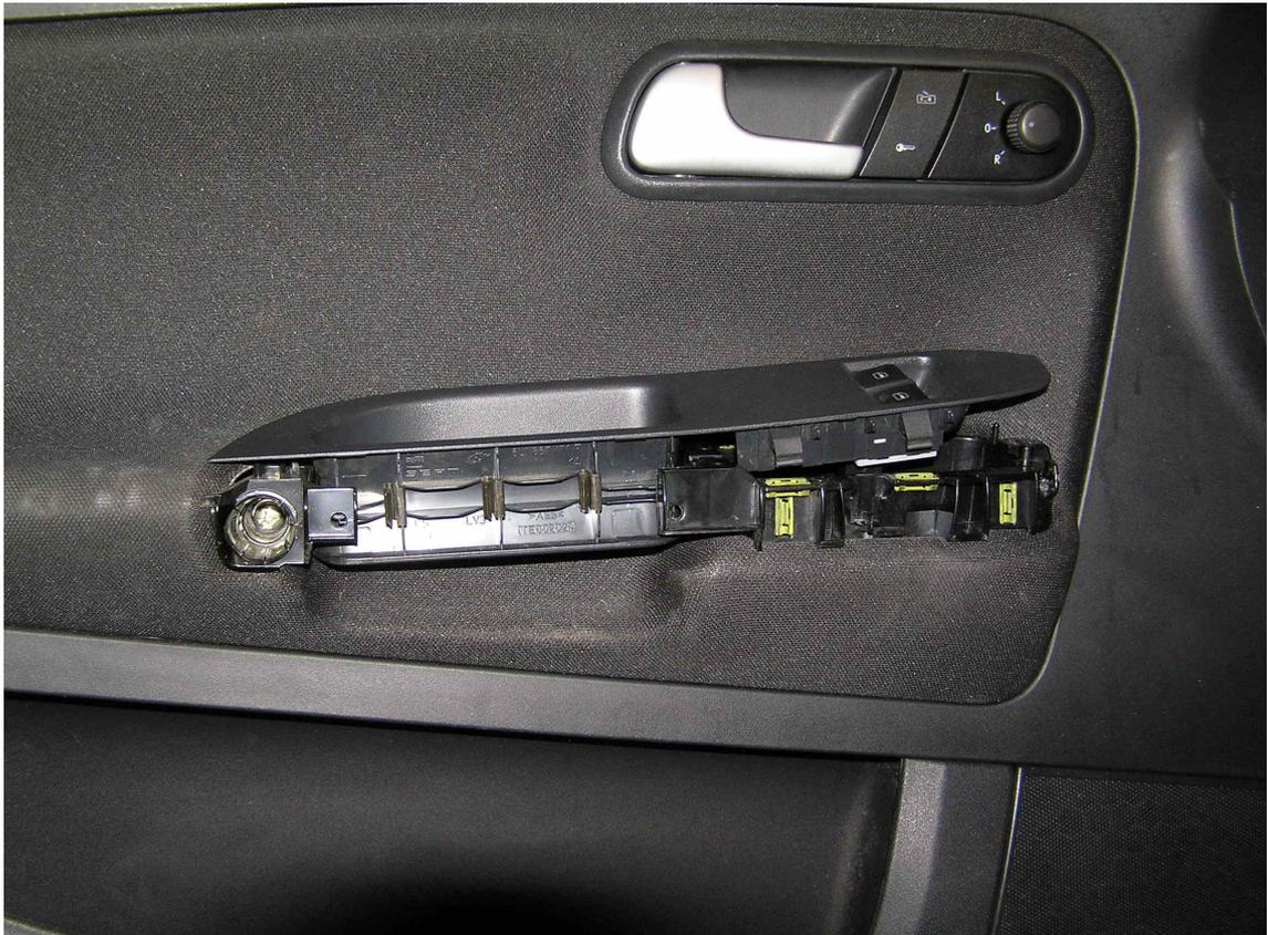
5. Die zwei Schrauben unter dem Türgriff entfernen
