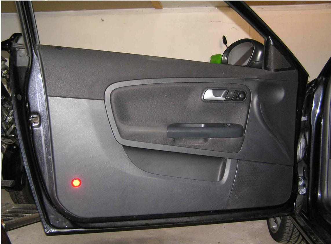
2. Torx 20 Schrauben an der Unterseite
