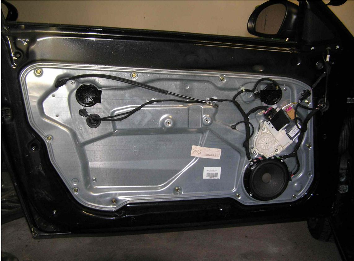
7. Die Scheibe hochfahren bis man durch die beiden "Gucklöcher" dieses Bild sieht und die Schrauben gleich lösen
